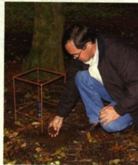
Mnr. Stephan Hoffman gebruik 'n vogmeter wat tot op 'n diepte van 800 mm meet hoeveel vog op watter diepte in die grond is.
